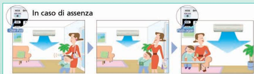
Prima di uscire, attivare la modalità di "funzionamento in caso di assenza", e il climatizzatore regolerà la capacità fino al raggiungimento della temperatura precedentemente impostata dall'utente per questa funzione.
